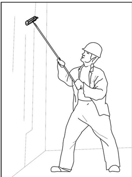
Е. Устройство декоративного слоя. Работы по отделке (выравниванию, текстурированию) поверхности можно начинать не ранее чем через три дня после нанесения армирующего слоя. Окраска поверхности осуществляется в два слоя при помощи мехового валика. Нанесение первого слоя краски производят не ранее чем через два дня после нанесения выравнивающего (текстурного) слоя штукатурки. Повторное окрашивание осуществляют через два дня.
